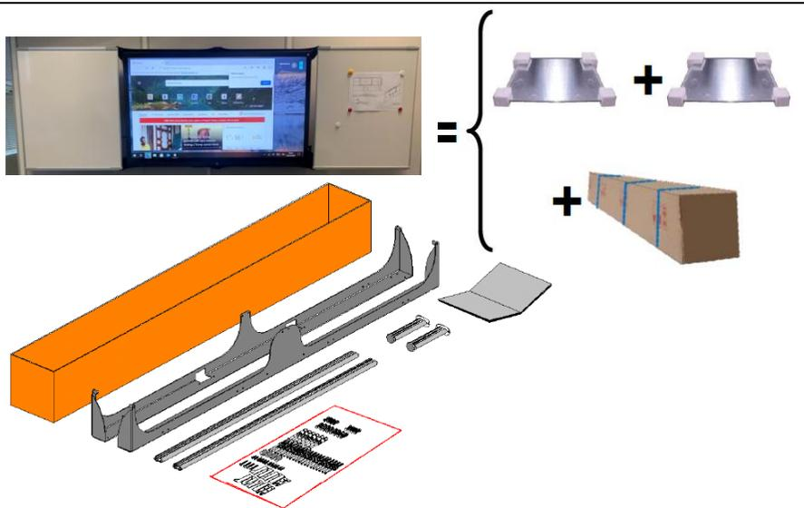
1) assembler la structure avec les 8 vis tchc m6x30 :
