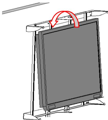
5) équiper et monter les deux volets sur la structure
